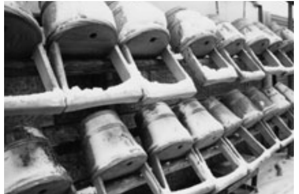
山廃仕込みに使用する木製の「暖気樽(ダンキダル)」。穴より熱湯を入れて栓をする。一度使用するたびに熱湯で消毒、日光で乾かす。これだけの数の木暖気は珍しい。
