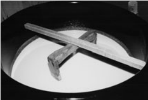
暖気樽使用中。樽の部分に熱湯を入れ酒母の中へ沈める。これにより品温を少しずつ上昇させ、乳酸発酵をうながし、酵母の健全な発育を助ける。最近の金属製の暖気樽では熱が急激に放射されるので、木暖気のほうがよいとされる。
