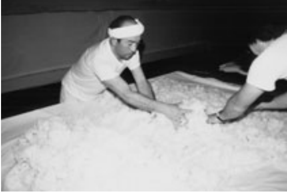
麴をつくる作業中。蒸米を麴室に引き込みバラバラにほぐす作業を「床もみ」と言う。
